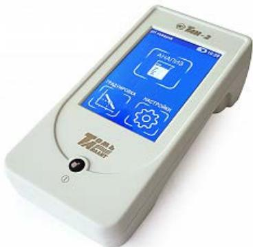
Анализатор потенциометрический рН-метр/иономер ТАН-2 предназначен для измерений водородного показателя (рН), концентрации ионов и окислительно-восстановительного потенциала (ОВП) жидких сред с одновременным измерением температуры.
