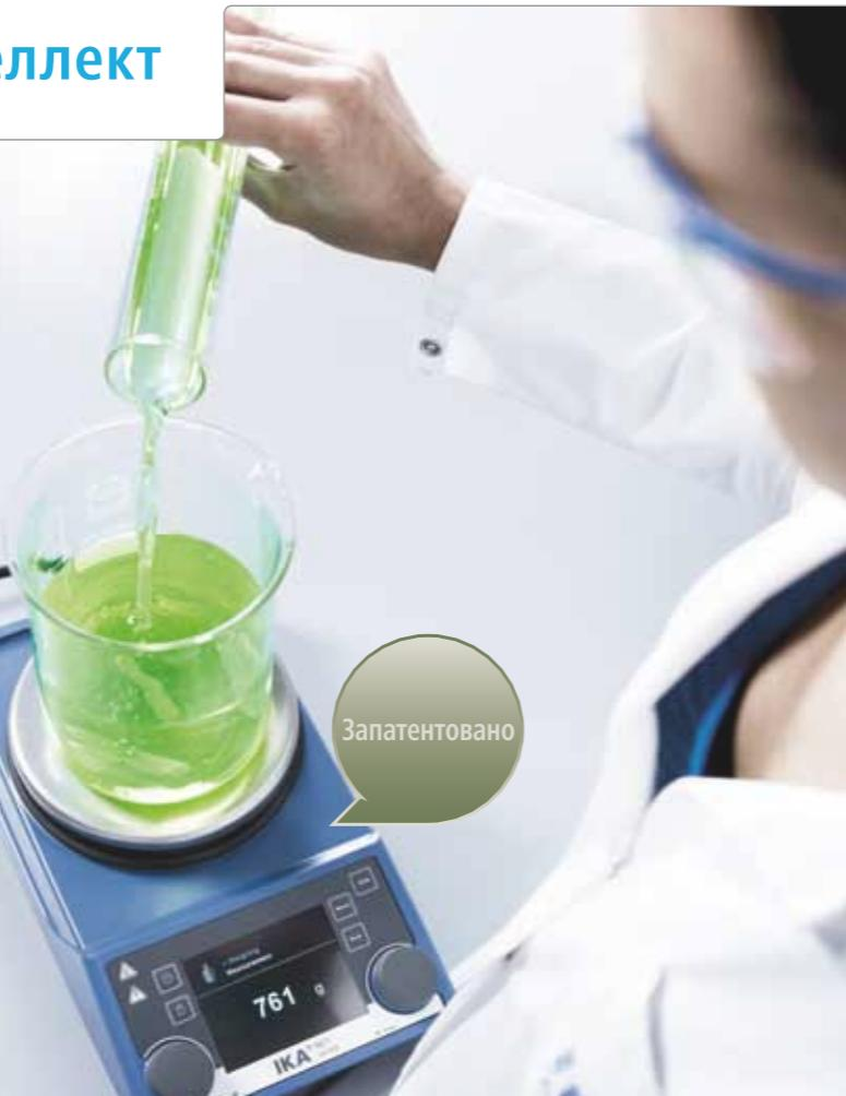
Сердцем RET control-visc является микроконтроллер, основанный на ARM, который также устанавливается в смартфоны и планшетные компьютеры. Использование этого основанного на ARM микроконтроллера обеспечивает, благодаря его техническому интеллекту, простоту навигации в меню, возможность обновления встроенного программного обеспечения, взвешивания и измерения направления крутящего момента.
