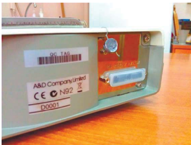
Рисунок 2 – Схема пломбировки весов
